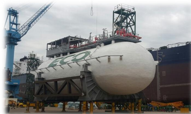
LNG Fuel Storage Tank 탑재대기
